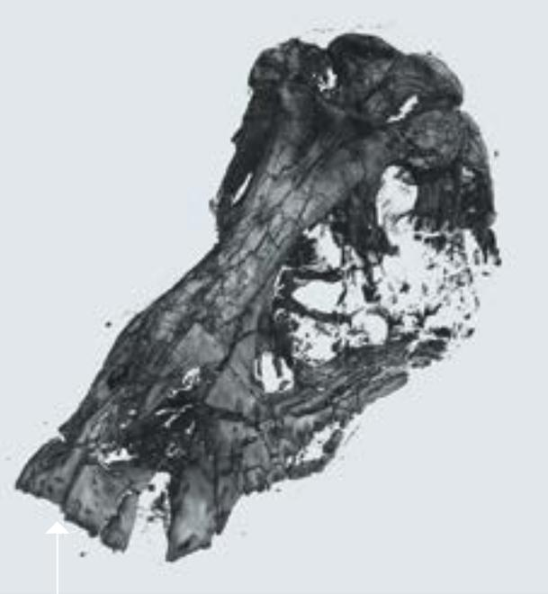
Durchleuchten großer Objekte in hochauflösenden, kontrastreichen 3D-Bildern mit dem XXL-Computertomographie-System des Fraunhofer-Entwicklungszentrums Röntgentechnik EZRT, hier ein Dinosaurierschädel
